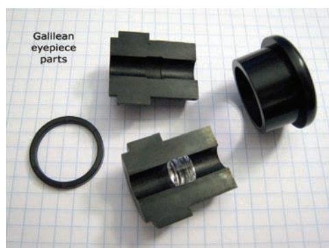
Figure 2 : pièces constituant l'oculaire de Galilée
